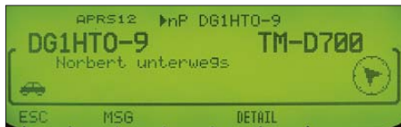
Bild 9: Eine neu empfangene APRS-Meldung zeigt das TM-D710E in einem eingblendeten Fenster an.
