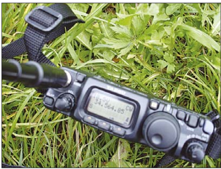
455 kHz unterhalb der Sendefrequenz arbeitet der Oszillator des Empfängers der Multiplex-Geräte. Fotos: DL3MGG
