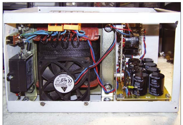
Bild 3: Links oben der 115-/230-V-Schalter, darunter ein Entstörglied; rechts unten die Hochspannungsplatine, daneben hochkant die Platine zur Versorgung der restlichen Spannungen
