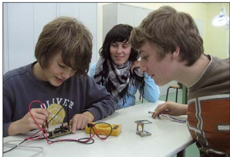
Arno Bohrer und Christian Konstroffer, beide 13 Jahre jung, unterziehen die fertiggestellten PSK31-Controller ihrer Mitschüler einer optischen und elektrischen Endabnahme. Foto: AATiS
