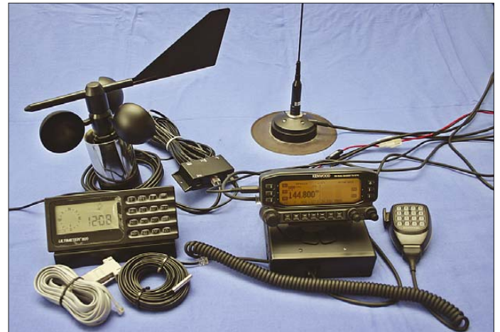
Bild 15: Hier ist eine kompatible Wetterstation angeschlossen. Das Bedienteil des TM-D710E steckt hier in der Mobilhalterung.
