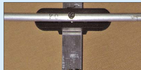
Bild 4: Isolierte Elementmontage mittel Halteklammer; die Schraube befindet sich im Spannungsnullpunkt und ist ohne Einfluss.
