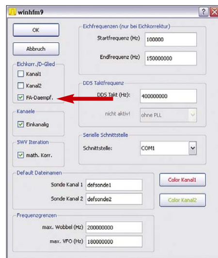
Bild 11: Im Menü Einstellungen → Optionen ist wählbar, welches Dämpfungsglied durch den FA-NWT angesteuert werden soll. Ist das Feld FA-Daempf. markiert, wird die hier vorgestellte Version unterstützt, ansonsten die klassische Variante mit 10-dB-Stufen.
