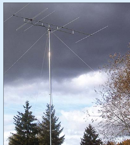
Bild 2: Yagi-Antennen werden im oberen KW-Bereich sowie im UKW-Bereich (hier eine 6-m-Antenne) häufig eingesetzt; sie lassen sich unter Beachtung einiger Grundregeln leicht selbst herstellen.
