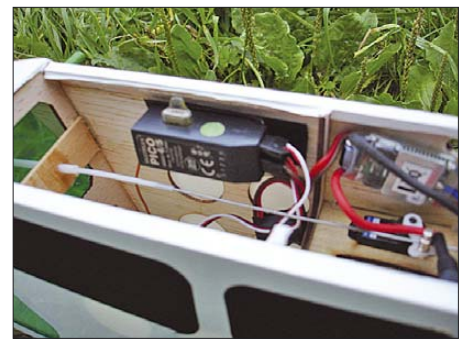
Der Oszillator des Empfängers ist im Leichtbaugehäuse kaum abgeschirmt und dadurch aus relativ großer Entfernung zu orten.
