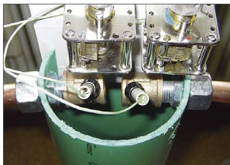
Bild 3: Modularer Aufbau der miniLOOP und Ermeto-Verschraubung
