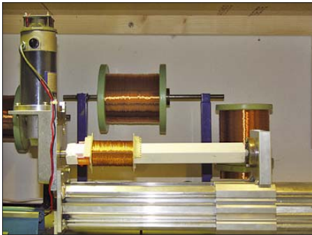
Bild 1: Wickelmaschine als Anwendungsbeispiel für einen Rampenbildner Foto: DG9WF
