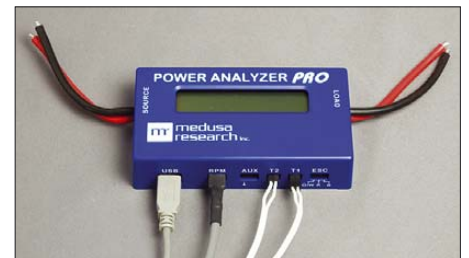
Bild 2: Power Analyzer Pro, zwei Temperatur- und ein Drehzahlsensor angeschlossen
