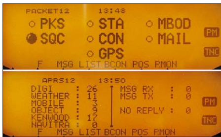
Bild 21: Für Packet-Radio (oben) und für APRS (unten im Bild) verfügt das RC-D710 über zwei weitere Statusanzeigen, die einen schnellen Überblick gewähren.
