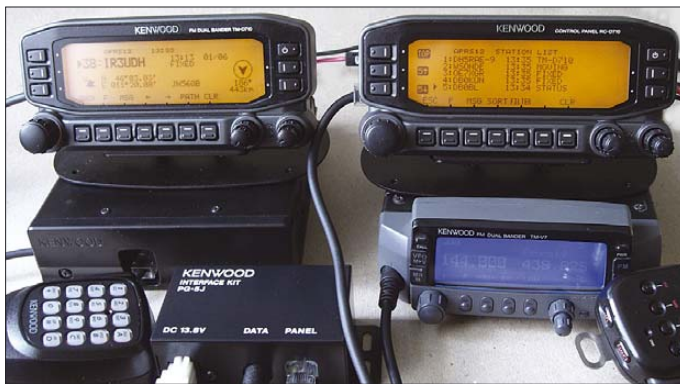
Bild 22: Im Vergleich mit dem Bedienteil des TM-D710E weist das RC-D710 kaum Unterschiede auf. Es bringt auch anderen Funkgeräten volle Datenfunktionalität. Das Interface PG-5J (links unten) ist an auffälliger Stelle montierbar. Für den Anschluss an das Mobilfunkgerät TM-V71E ist es überflüssig.
